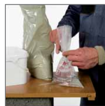
4. Щільно зв'язати торбинку самозатисною стрічкою.
